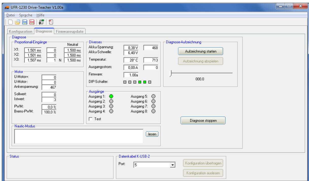
Im Drive-Teacher ist eine Diagnosefunktion integriert, mit deren Hilfe verschiedene Funktionen des Fahrtreglers überprüfen kann. Dazu muss das Datenkabel [K-USB-2](#) an den Fahrtregler an X6/1 (unten) angeschlossen werden.
