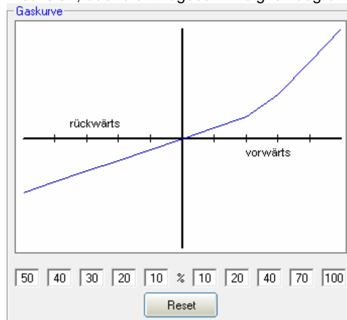
Durch einen Klick auf „Reset“ wird die Gaskurve wieder auf einen linearen Ausgangswert gesetzt.
